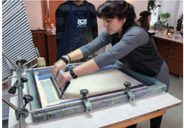
Görsel 3.62: Ragle ile boyanın çekilmesi
