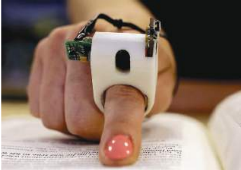
Görsel 9: İçindeki yazılım sayesinde algıladığı metinleri sese çevirebilen "FingerReader/ OkuyanParmak" özellikle görme engelli bireylerin eğitiminde kullanılabilir.
