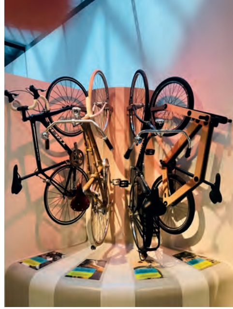
Görsel 1: Farklı Malzemelerle (karbonfiber, bambu, çelik, ahşap) Tasarlanmış Bisikletler, Konya Bilim Merkezi.
