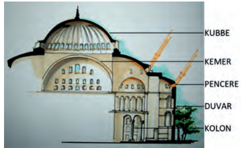
Görsel 7: Mekânı Oluşturan Yapısal Öğeler, Ayasofya Örneği, İstanbul.
