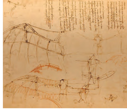
Görsel 1: Leonardo Da Vinci'nin Ejderha Sineğinden Yola Çıkarak Tasarladığı Mekanik Kanat Mekanizmaları
