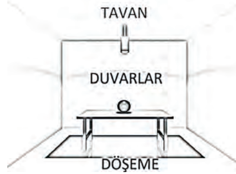
Görsel 10: Yapıda Mekânı Sınırlayan Öğeler: Döşeme, Tavan ve Duvarlar.
