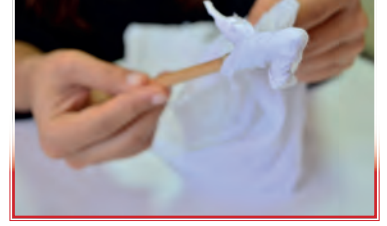
Görsel 1.22.c. Temizleme bezinin temizleme çubuğuna sarılması
